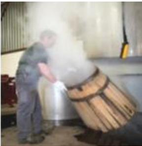
La piegatura a “vapore” avviene attraverso l’immersione della *barrique* sotto una campana satura di vapore per epurare il legno di alcune sostanze fenoliche dalle caratteristiche astringenti. Questa procedura permette un’ estrazione ottimale degli aromi e una più evidente espressione del frutto.
