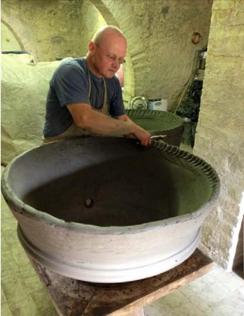
L'artigiano impasta la terra cruda con acqua, dando passo a passo forma all'orcio. Questo lavoro richiede tempi adeguati per permettere all'argilla di asciugare molto lentamente ed acquisire così caratteristiche uniche di durezza e resistenza. Prima della cottura, l'orcio deve attendere diversi mesi in funzione di temperatura, umidità e dimensioni.
